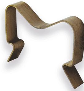
Montage-Clipse dienen zur sicheren rationellen Montage von Halbleitern auf Kühlkörpern mit entsprechendem Lochbild. Insbesondere bei isolierter Montage entsteht eine höhere Sicherheit durch Verzicht auf Schrauben und Isolierbuchse. Der Zentrale Anpressdruck gewährleistet einen gleichbleibend guten Wärmeübergang vom Halbleiter zum Kühlkörper.
