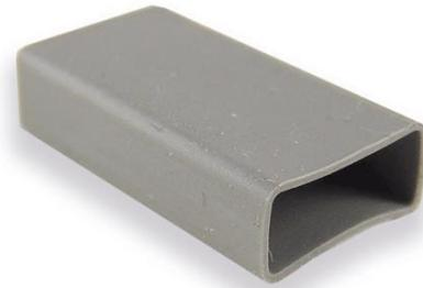
Isolierkappen aus hochwärmeleitendem Silikon Gummi vereinfachen den isolierten Aufbau von Halbleitern z.B. auf Kühlkörpern. Besonders geeignet für rationelle Clip-Montage. z.B. für Gehäuse TO220
