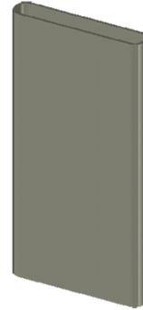
Isolierschläuche aus hochwärmeleitendem Silikon Gummi vereinfachen den isolierten Aufbau von Halbleitern z.B. auf Kühlkörpern. Besonders geeignet für rationelle Clip-Montage. z.B. für Gehäuse TO220
