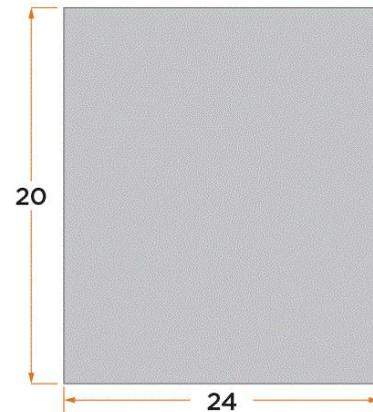
Silikonfolien (glasfaserverstärkt) dienen in Verbindung mit Isolierbuchsen zur isolierten Montage von Halbleitern z.B. auf Kühlkörpern. Einseitig selbstklebend.
