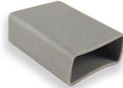
Isolierkappen aus hochwärmeleitendem Silikon Gummi vereinfachen den isolierten Aufbau von Halbleitern z.B. auf Kühlkörpern. Besonders geeignet für rationelle Clip-Montage. z.B. für Gehäuse TO220
