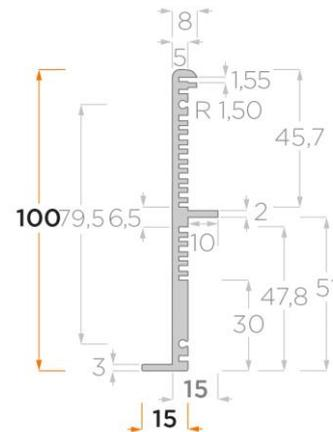
Universal-Seitenprofil aus Aluminium z.B. zur Konstruktion eines Wärmeableitgehäuses mit Kühlprofilen.
