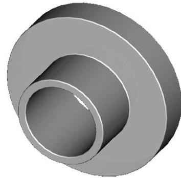
Isolierbuchse dient in Verbindung mit Isolierscheiben aus Silikon oder Glimmer zur isolierten Montage von Halbleitern z.B. auf Kühlkörpern
