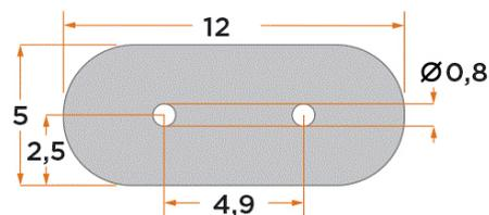
Silikonfolien (glasfaserverstärkt) dienen in Verbindung mit Isolierbuchsen zur isolierten Montage von Halbleitern z.B. auf Kühlkörpern.
