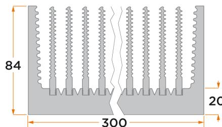
Standard-Profilkühlkörper einseitig verrippt (Kammprofil) mit eingepressten Vollrippen (24 Rippen)
