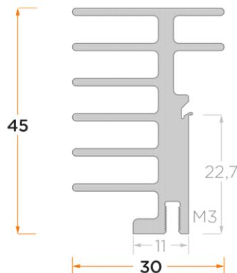
Standard-Profilkühlkörper für Clip-Montage mit den Clip-Typen: MC725, MC 726, MC 773, MC 797
