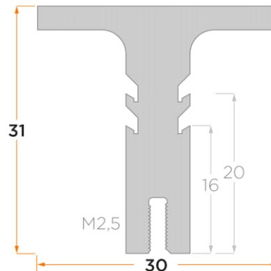
Standard-Profilkühlkörper für Clip-Montage mit den Clip-Typen: MC725, MC 726, MC 773, MC 797
