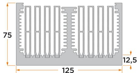
Standard-Profilkühlkörper einseitig verrippt (Kammprofil) mit eingepressten Hohlrippen für Frembelüftung
