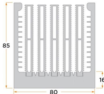
Standard-Profilkühlkörpereinseitig verrippt (Kammprofil) mit eingepressten Hohlrippen für Frembelüftung
