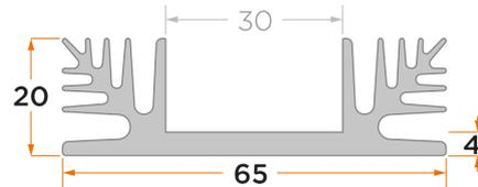
Standard-Profilkühlkörper mit versenkter Montagefläche
