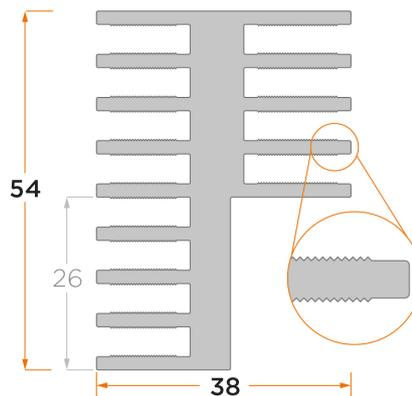
Standard-Profilkühlkörper für Schraubmontage
