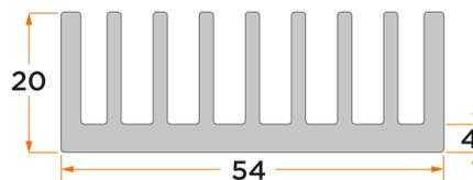
Standard-Profilkühlkörper für Schraubmontage
