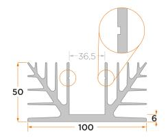
Standard-Profilkühlkörper mit versenkter Montagefläche
