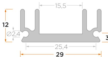
Standard-Profilkühlkörper mit versenkter Montagefläche
