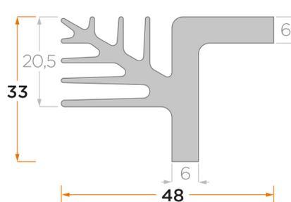
Standard-Profilkühlkörper für Schraubmontage
