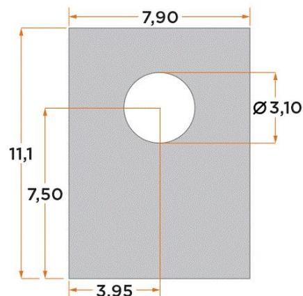
Silikonfolien (glasfaserverstärkt) dienen in Verbindung mit Isolierbuchsen zur isolierten Montage von Halbleitern z.B. auf Kühlkörpern.
