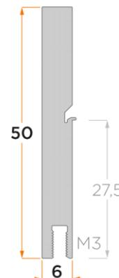
Standard-Profilkühlkörper für Clip-Montage mit den Clip-Typen: MC725, MC 726, MC 773, MC 797
